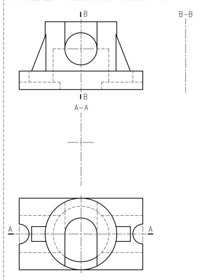
六. 参照立体图,按近似1:1画出组合体的三视图。[45分]要求:1.不标注尺寸,允许从图中量取大小; 2.图中已画出中心线位置。
